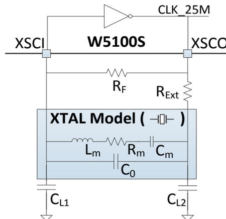
External load capacitor  $C_{L1}$  과  $C_{L2}$  는 동일한 값이며 아래와 같은 공식에 의해 정해진다.
